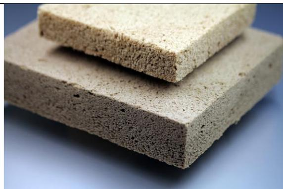
Im Fraunhofer WKI gefertigte Platten aus Holzschaum.
